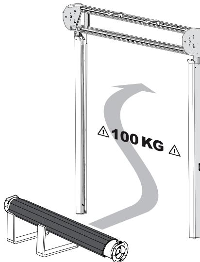
Instale el rodillo superior junto con el panel de la puerta.
