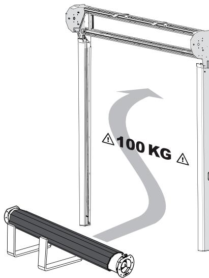
Instale o rolo superior juntamente com o painel da porta.
