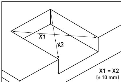
Consejo: A lo ancho el puente de sobrecarga deberá montarse totalmente horizontal. Por otro lado la funcionalidad del puente de sobrecarga puede verse limitada. De igual manera existe el peligro de daños en el puente de sobrecarga.
