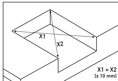
Hinweis: In der Breite muss die Überladebrücke exakt waagerecht eingebaut werden. Andernfalls kann die Funktionsfähigkeit der Überladebrücke eingeschränkt sein. Ebenso besteht die Gefahr einer Beschädigung der Überladebrücke.
