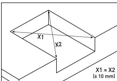
Instructie: De leveller moet in de breedte exact horizontaal worden ingebouwd. Anders kan de functionaliteit van de leveller worden ingeperkt. Bovendien kan de leveller beschadigd raken.
